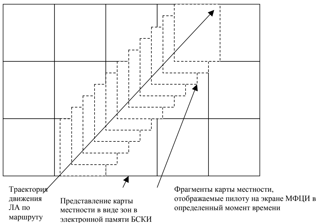
Рис. 1. Организация отображения фрагмента карты местности, расположенной в электронной карте памяти БСКИ, на экране индикаторов МФЦИ.
