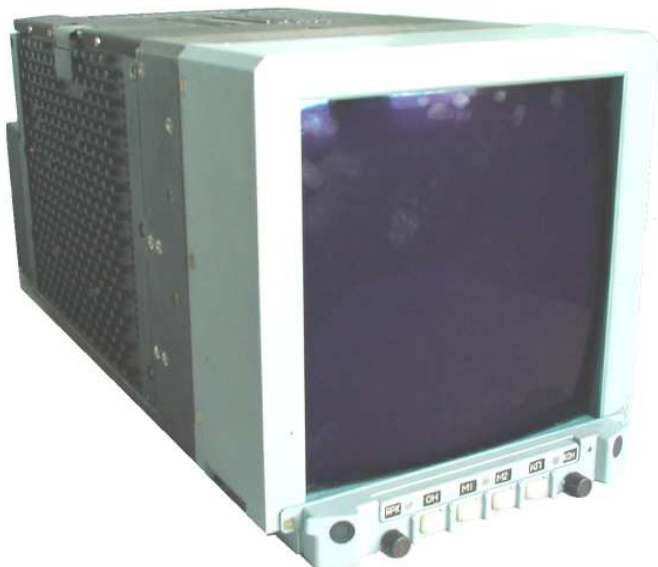
Рис.4. Функциональный индикатор на основе электронно-лучевой трубки (на примере продукции ФГУП «Санкт-Петербургское ОКБ «Электроавтоматика»).
