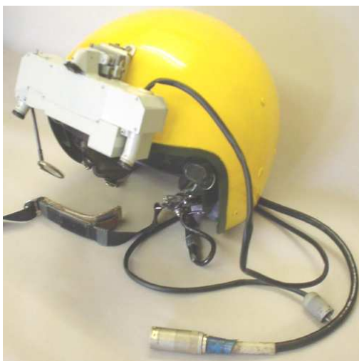
Рис.2. Нашлемная система целеуказания и индикации НСЦИ (на примере продукции ФГУП «Санкт-Петербургское ОКБ «Электроавтоматика»).
