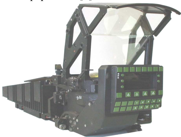
Рис.1. Авиационный индикатор на лобовом стекле: (на примере продукции ФГУП «Санкт-Петербургское ОКБ «Электроавтоматика»).
