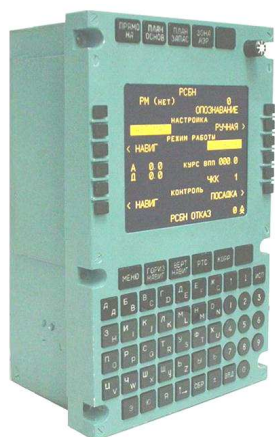
Рис.3. Пульты управления и индикации ПУИ (на примере продукции ФГУП «Санкт-Петербургское ОКБ «Электроавтоматика»).
